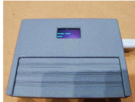
Рис. 3. Зовнішній вигляд готового демонстраційного прототипу квантового генератора випадкових чисел. 3
