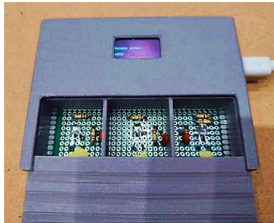
Рис. 3. Зовнішній вигляд готового демонстраційного прототипу квантового генератора випадкових чисел. 3
