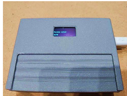
Рис. 3. Зовнішній вигляд готового демонстраційного прототипу квантового генератора випадкових чисел. 3
