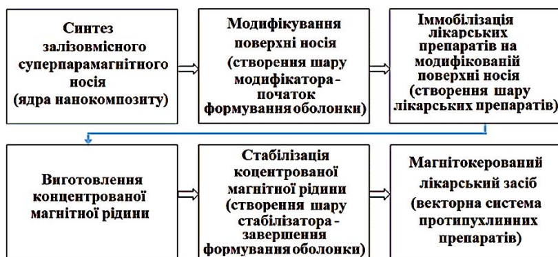
Рис. 5. Технологічна схема виготовлення нового магнітокерованого поліфункціонального лікарського засобу — протипухлинної векторної системи. 6
