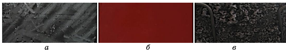
Рис. 3. Зовнішній вигляд крицевої пластини, яка використовувалася в якості каталітичної підкладки. а — початковий стан; б — окиснений стан; в — стан з осадженим вуглецевим наноматеріалом. 3
