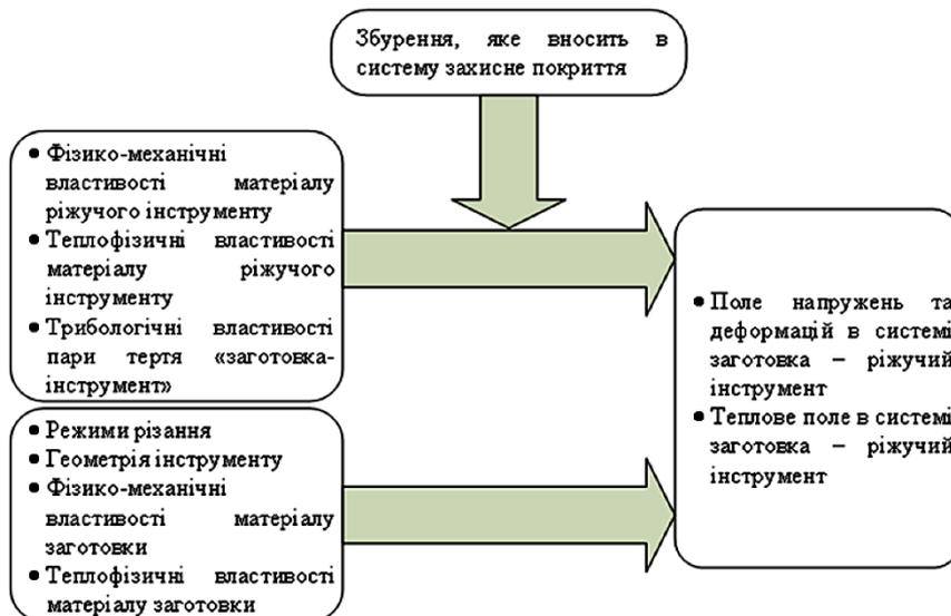
**Рис. 10.** Вплив різних чинників на формування полів деформацій, напружень і теплового поля за механічного оброблення.<sup>10</sup>
