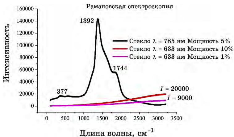
Рис. 2. Спектр КР стекла (cat.no.7102, China). Максимальная мощность излучения лазера (633,785 нм) — 100 мВт и 300 мВт соответственно. 2
