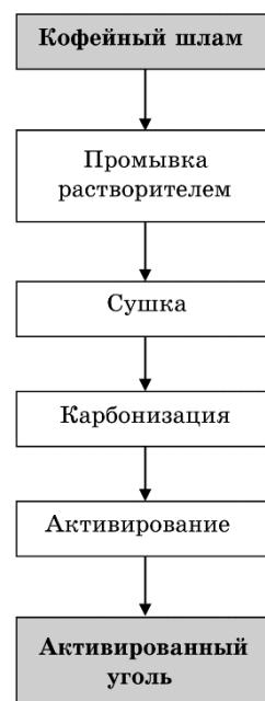
**Рис. 1.** Блок-схема получения активированного угля из кофейного шлама.<sup>2</sup>
