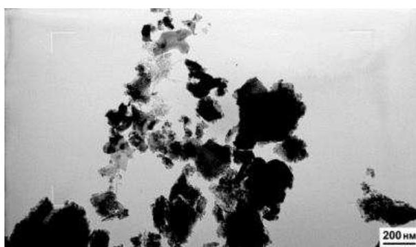
Рис. 1. Микрофотография композита  $\text{Al}_2\text{O}_3/\text{МУНТ}$ , содержащего 3% вес. УНС.
