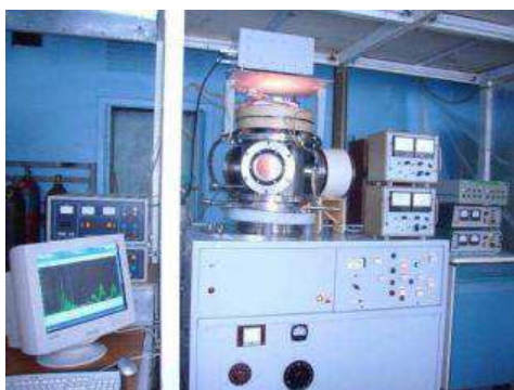
Рис. 1. Гибридная геликонно-дуговая ионно-плазменная система.
