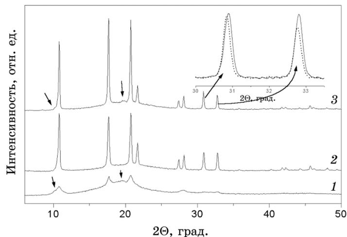
**Рис. 6.** Порошковые дифрактограммы фуллеритов, полученных: 1 — при осаждении толуольного раствора изопропиловым спиртом; 2 — сублимацией в вакууме; 3 — при низкотемпературном осаждении свежего бензольного раствора этиловым спиртом. Короткими стрелками помечены пики, которые можно отнести к ГПУ фазе. На вставке показано наложение дифрактограмм 2 (сплошная линия) и 3 (пунктир).
