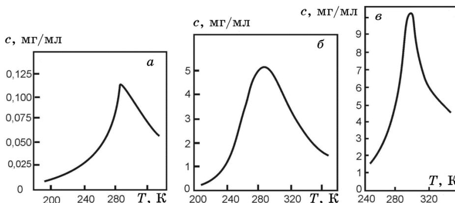
**Рис. 1.** Экспериментальные графики температурной зависимости растворимости фуллерида C<sub>60</sub> в гексане (а), толуоле (б), ксилоле (в).
