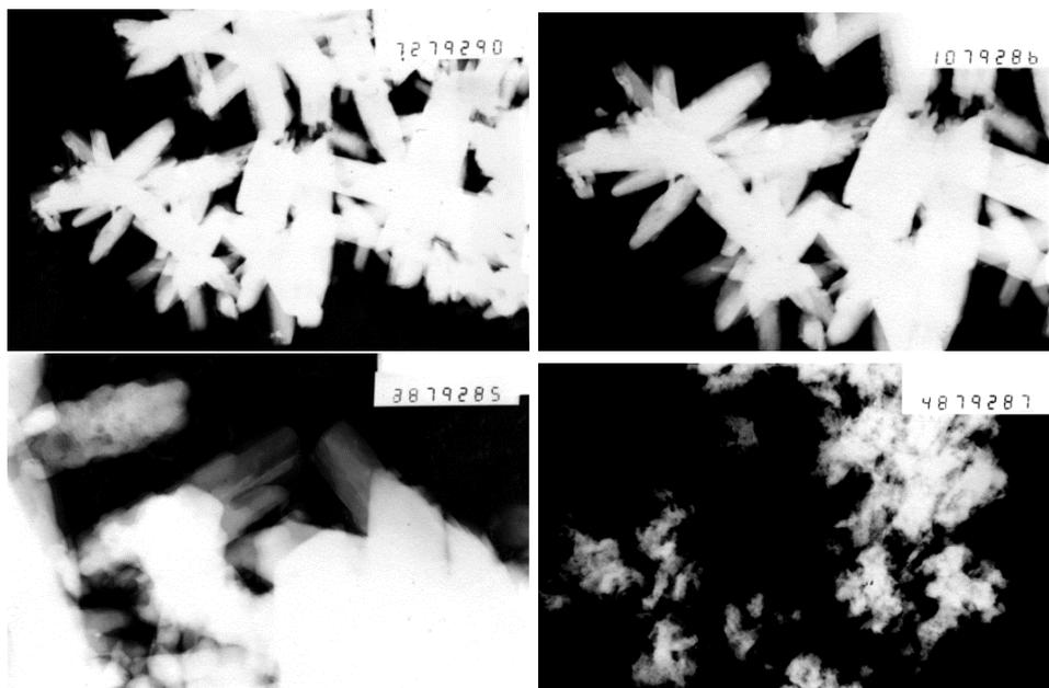
**Рис. 11.** Фуллерит, полученный методом высаливания из раствора  $C_{60}$  в толуоле при  $T_{\text{раствора}} = 273 \text{ К}$  и  $T_{\text{высаливателя}} = 273 \text{ К}$  (образец № 36). Результаты просвечивающей электронной микроскопии на чёрном поле: *a* и *б* — монокристаллы; *в* — сrostки монокристаллов; *г* — рентгеноаморфная составляющая.
