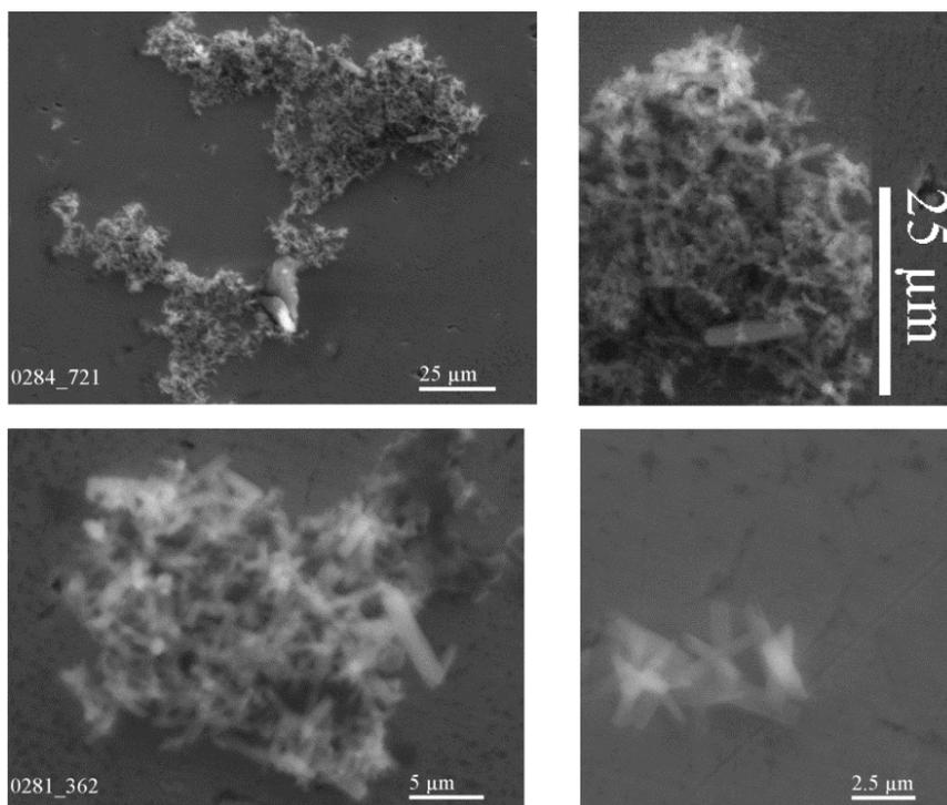
**Рис. 9.** Сrostки монокристаллов фуллерита, образующие кластеры величиной 40–150 мкм (образец № 8), сформированные при высаливании фуллерита из раствора  $C_{60}$  в толуоле при  $T_{\text{раствора}} = 273 \text{ К}$  и  $T_{\text{высаливателя}} = 243 \text{ К}$  (результаты сканирующей электронной микроскопии на чёрном поле). Приведены снимки кристаллов различной степени увеличения.
