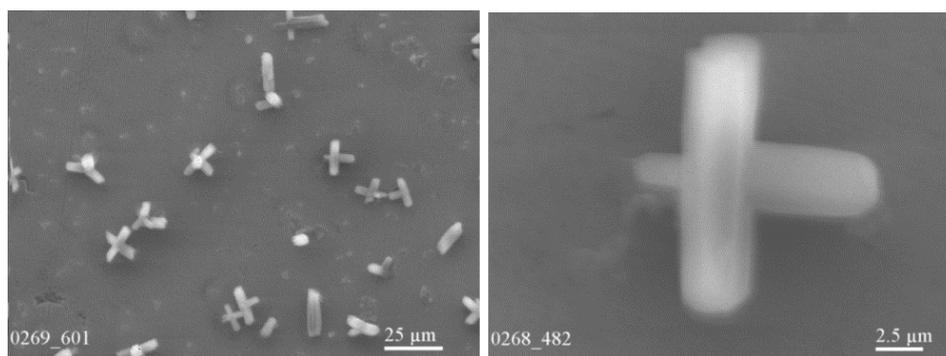
**Рис. 8.** Сrostки монокристаллов фуллерита (образец № 0), выращенные методом выпаривания в объёме капли раствора  $C_{60}$  в толуоле (результаты сканирующей электронной микроскопии).
