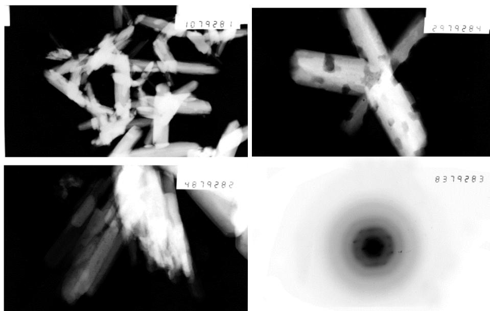
**Рис. 10.** Монокристаллы фуллерита (образец № 8), сформированные при высаливании фуллерита из раствора  $C_{60}$  в толуоле при  $T_{\text{раствора}} = 273$  К и  $T_{\text{высаливателя}} = 243$  К. Результаты просвечивающей электронной микроскопии.
