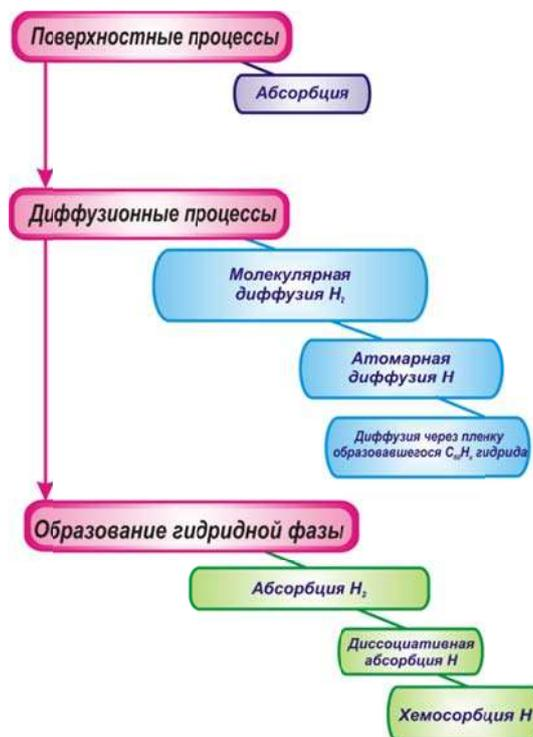
Рис. 10. Гипотетическая модель процессов, протекающих при взаимодействии газообразного водорода с фуллеритом.
