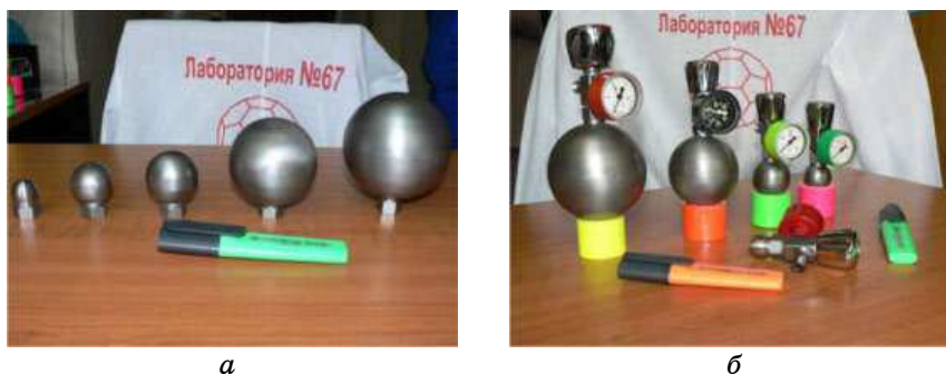
Рис. 3. Сосуды высокого давления для хранения водорода и накопители водорода модификации «Alsav» емкостью 3, 10, 15, 75 и 170 литров.
