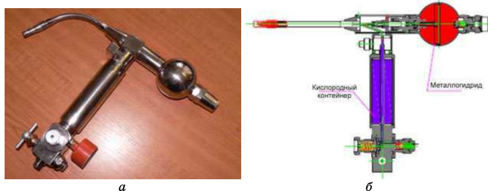
Рис. 8. Водородно-кислородная горелка с металлогидридным аккумулятором водорода, баллоном высокого давления для кислорода и пьезоэлектрическим поджигом факела.
