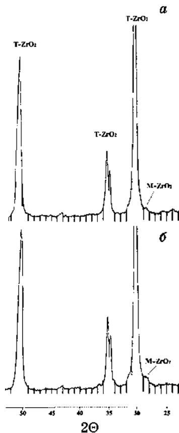
**Рис. 4.** Рентгенограммы материала из нанокристаллического порошка в системе  $ZrO_2$ - $Y_2O_3$ - $CeO_2$  после: *а* — спекания при  $1300^\circ\text{C}$  2 ч на воздухе; *б* — обработки спеченных образцов ( $1300^\circ\text{C}$ , 2 ч) в гидротермальных условиях при  $140^\circ\text{C}$  20 ч.
