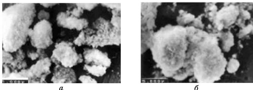
Рис. 2. Морфология нанокристаллических порошков  $ZrO_2$  после гидротермальной (а) и механохимической (б) обработки.
