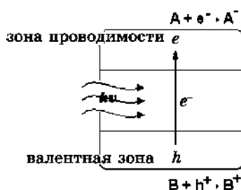
Рис. 1. Принцип действия фотокатализатора.
