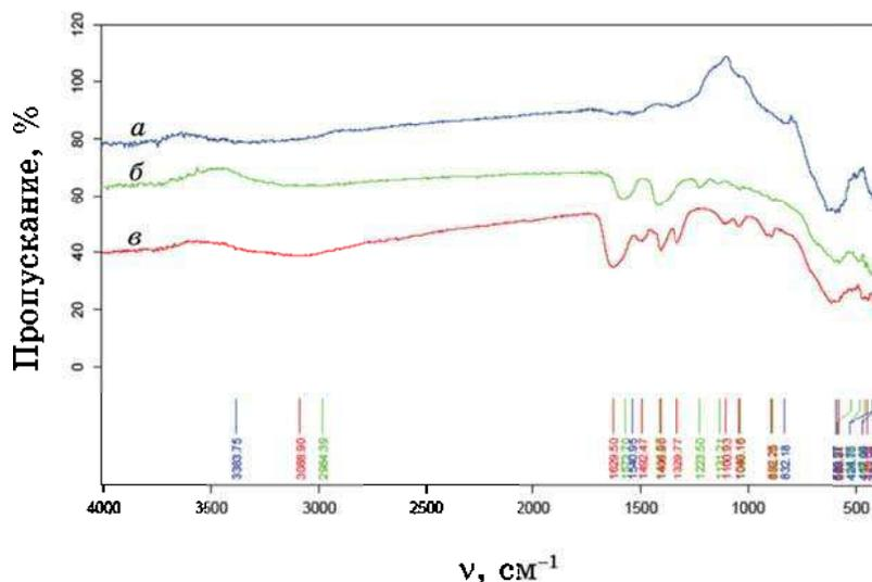
**Рис. 1.** ИК-спектры диффузного отражения: *a* —  $\text{Fe}_3\text{O}_4$ ; *b* —  $\text{Fe}_3\text{O}_4$ , модифицирование аминоксусной кислотой; *c* —  $\text{Fe}_3\text{O}_4$ , модифицирование меркаптоуксусной кислотой.
