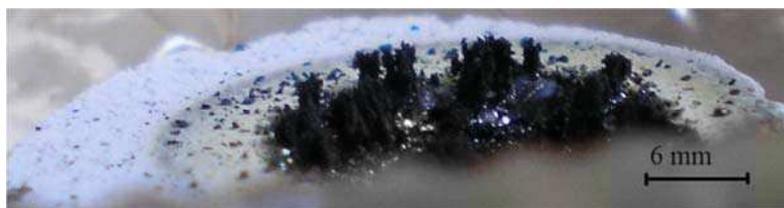
**Рис. 3.** Структуры, сформированные на поверхности образца из уплотненного порошка композита *h*-BN–ламповая сажа.
