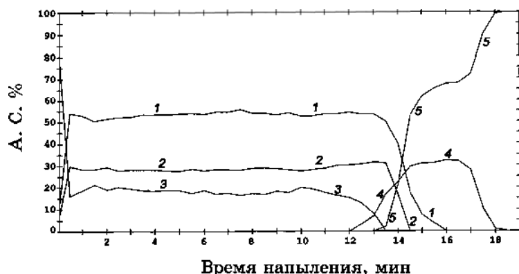
Рис. 5. Оже-спектр распределения концентраций основных элементов структуры АОА с синтезированными УНТ: 1 — кислород (O); 2 — алюминий (Al); 3 — углерод (C); 4 — титан (Ti); 5 — кремний (Si).
