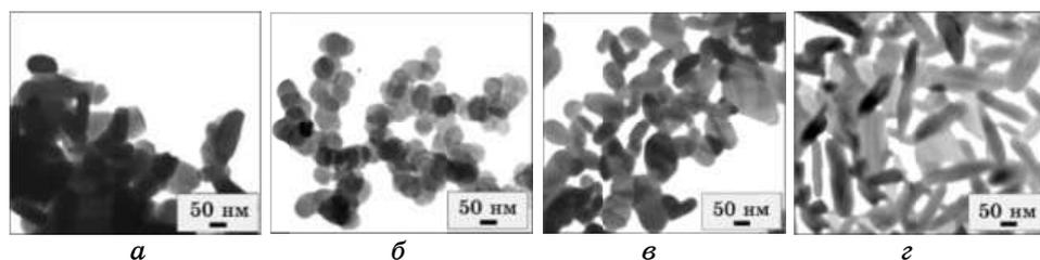
**Рис. 3.** Микрофотографии прокалённых ( $T = 1273$  К) образцов серии I, полученных при различных рН осаждения (*a* и *б* — осаждение при рН = 3,5 и 4,3 соответственно) и прокалённых ( $T = 1173$  К) образцов серии II, полученных золь-гель-методом с различным соотношением СА/ЕГ и при разных рН (*в* и *г* — СА/ЕГ = 0,25, рН = 9 и СА/ЕГ = 0,33, рН = 8 соответственно).
