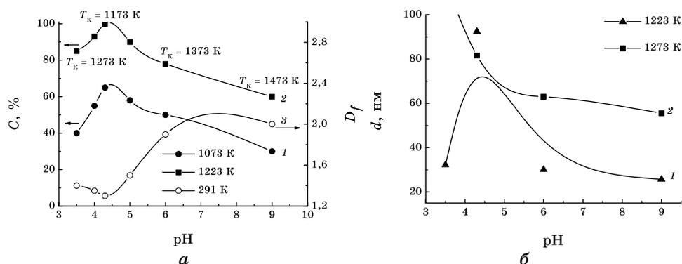
**Рис. 1.** Зависимость выхода ГФБ ( $C$ , % — 1, 2), фрактальной размерности прекурсоров первого структурного уровня серии I ( $D_f$  — 3) (а) и размера частиц ( $d$ , нм — 1, 2) (б) от pH осаждения.  $T_k$  — температура достижения однофазности при различных pH (3,5, 4,3, 6 и 9).
