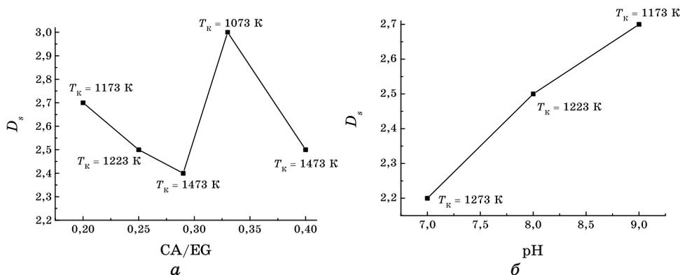
**Рис. 2.** Зависимость фрактальной размерности ( $D_s$ ) золь–гель-прекурсоров (серия II) первого структурного уровня от соотношения СА/ЕГ (при рН = 8) (а) и рН золь–гель-системы СА/ЕГ = 0,25 (б).  $T_k$  — температура достижения однофазности при различных соотношениях СА/ЕГ (а) и рН (б).
