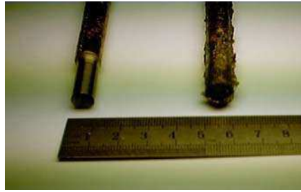
Рис. 2. Нанокристалічний стрижень Zr_{50}Cu_{30}Al_{10}Ni_{10} ( d = 10 мм).
