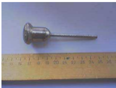
Рис. 1. Аморфний стрижень Zr_{50}Cu_{30}Al_{10}Ni_{10} ( d = 4 мм).
