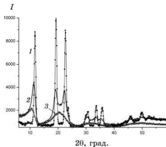
**Рис. 1.** Аморфизация фуллеритов при низкоскоростном размоле  $C_{60}$ : 1 — исходный кристаллический  $C_{60}$ ; 2 — 24 часа размола; 3 — 48 часов размола.
