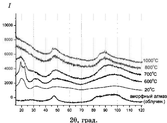
Рис. 5. Отжиг аморфного фуллерита  $C_{60}$ .
