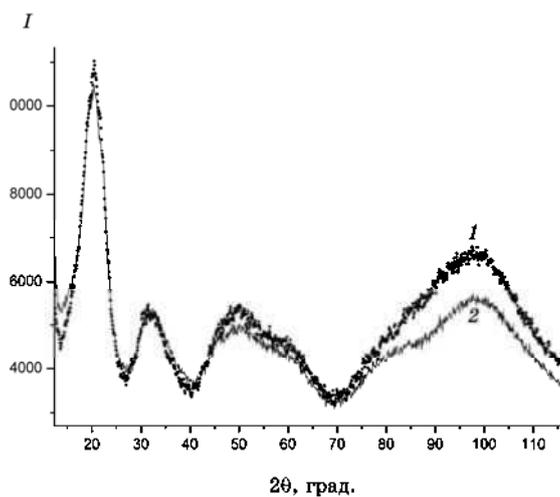
**Рис. 2.** Аморфизация фуллерита  $C_{60}$  на воздухе (1) и в инертной среде — в гелии (2).
