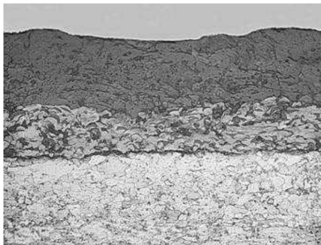
Рис. 1. Микроструктура поперечного среза железа с двухслойным композиционным плазменным покрытием из порошков NiAl и Al_2O_3/Ti ( \times 400 ).
