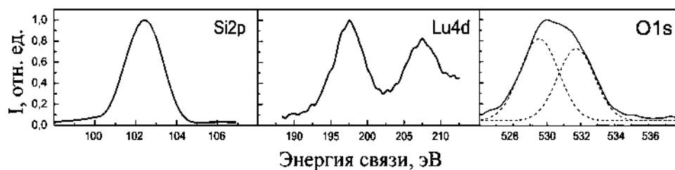
Рис. 4. Нормированные рентгеновские фотоэлектронные спектры Si2p-, Lu4d- и O1s-основных оболочек с поверхности образца гетерочастиц SiO 2 /Lu 2 O 3 -1.
