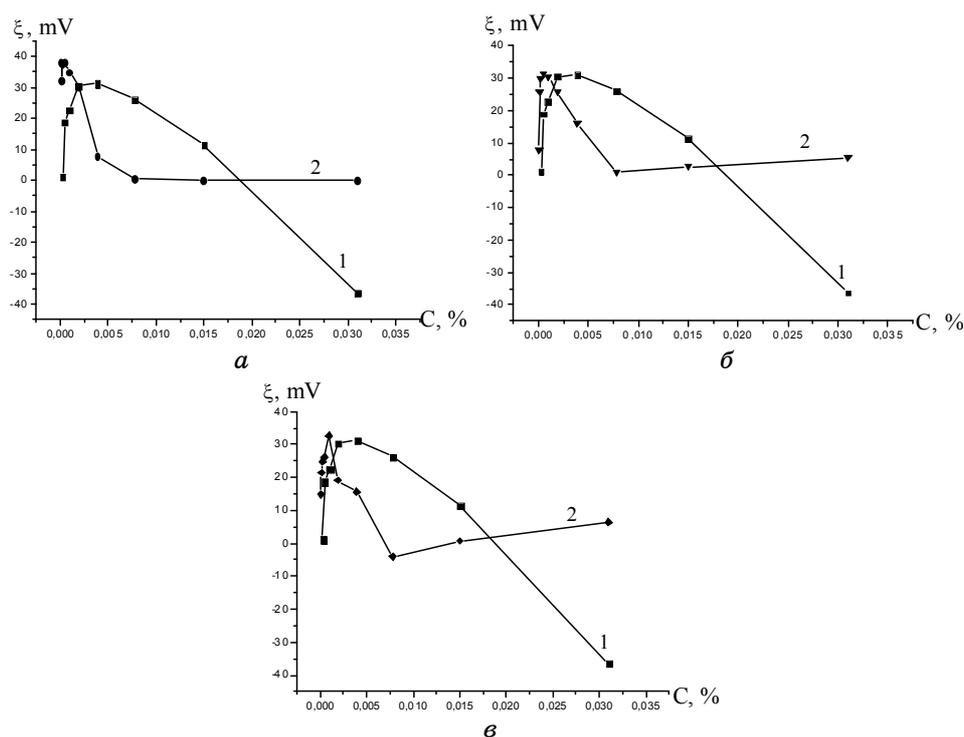
**Рис. 3.** Зависимость  $\xi$ -потенциала от концентрации водных растворов ПАВ: *а* — диамин (1) и диамин + этиленгликоль (2); *б* — диамин (1) и диамин + глицерин (2); *в* — диамин (1) и диамин + гексан (2).
