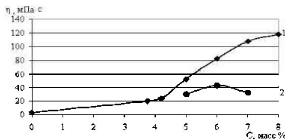
**Рис. 4.** Зависимость эффективной вязкости ильницкого бейделлита (1) и дашуковского монтмориллонита (2) от концентрации  $\text{Na}_2\text{CO}_3$  (по отношению к массе высущенного при  $75^\circ\text{C}$ , 1 сутки глинопорошка) в дисперсиях глинистых минералов. Содержание дисперсной фазы — 6 масс. %.
