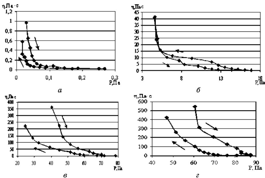
Рис. 3. Реологические кривые вязкости природного (а, б) и модифицированного  $Na_2CO_3$  (в, г) ильницкого бейделлита при содержании дисперсной фазы глинистого минерала 15 масс. % (а, в) и 25 масс. % (б, г), соответственно.
