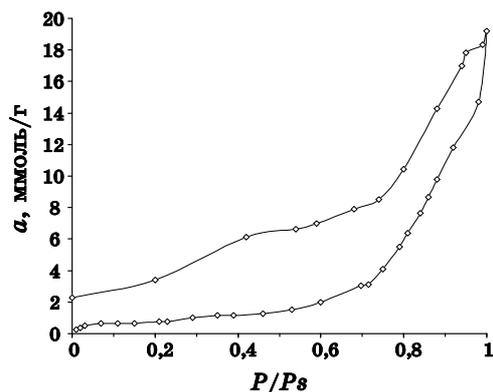
Рис. 1. Кривые сорбции–десорбции паров воды ( $a$ , ммоль/г) для сополимерного гидрогеля с 50%-ным содержанием звеньев АК.
