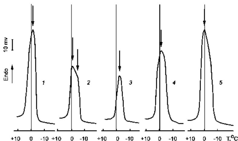
**Рис. 5.** Эндотермы плавления льда в гидрогелевых сополимерах акриламида с акриловой кислотой (1 —  $C_{\text{пол}} = 5\%$ ; 2 —  $C_{\text{пол}} = 10\%$ ; 3 —  $C_{\text{пол}} = 15\%$ ; 4 —  $C_{\text{пол}} = 20\%$ ; 5 —  $C_{\text{пол}} = 25\%$ ;  $C_{\text{МБА}} = 0,34$ ;  $C_{\text{АК}} = 50\%$ ;  $d = 0,4$  мм).
