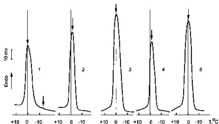
Рис. 4. Эндотермы плавления льда в гидрогелевых сополимерах акриламида с акриловой кислотой (1 —  $C_{\text{АК}} = 0\%$ ; 2 —  $C_{\text{АК}} = 25\%$ ; 3 —  $C_{\text{АК}} = 50\%$ ; 4 —  $C_{\text{АК}} = 75\%$ ; 5 —  $C_{\text{АК}} = 100\%$ ;  $C_{\text{пол}} = 15\%$ ;  $C_{\text{МБА}} = 0,173\%$ ;  $d = 0,5 \text{ мм}$ ).
