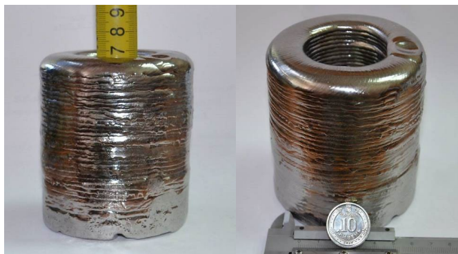
Рисунок 1 – Загальний вигляд монокристалу вольфраму у вигляді порожнистого тіла обертання Ø 85 мм
