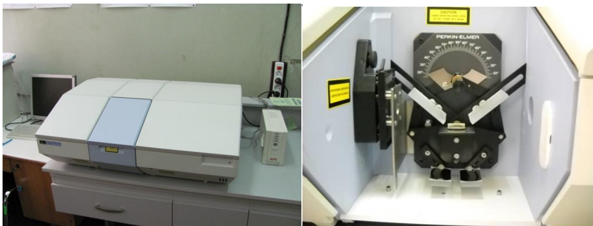
Рис. 2.30 ІЧ Фур'є-спектрометр Spectrum BX II та приставка для вимірювання коефіцієнта відбивання.
