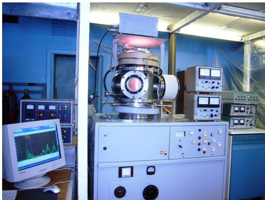
Рис. 2.1 Установка іонно-плазмового формування плівкових покриттів.
