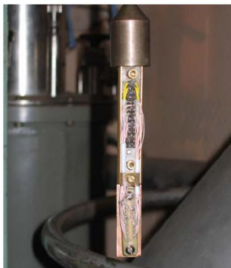
Рис. 2.26 Маніпулятор з кріпленнями у вигляді металевих «ніжок» для підводу струму і вимірюванні напруги.
