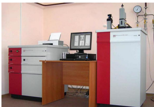
Рис. 2.29 СКВІД-магнітометр моделі MPMS-XL5 виробництва фірми "Quantum Design" (США)
