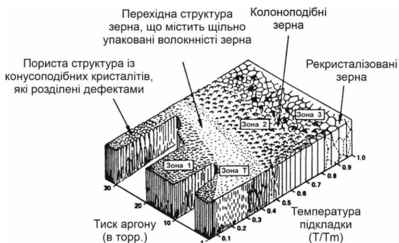
Рис. 4.6. Модель структурних зон згідно Торнтону [139]
