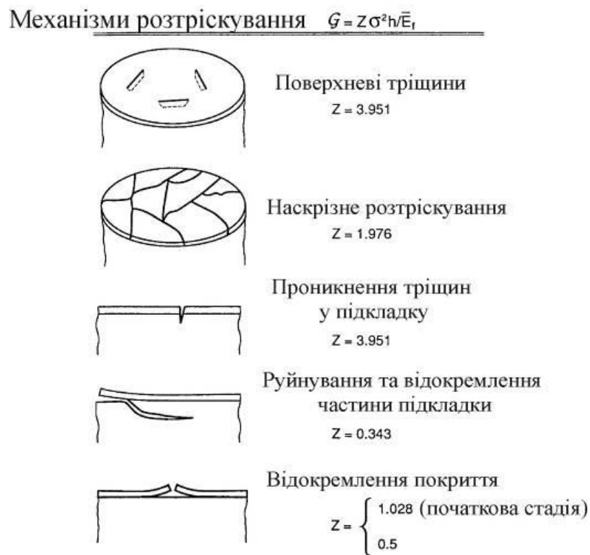
Рис. 4.20. Найбільш поширені механізми релаксації макронапружень (із роботи [222]). Наведено величини безрозмірного параметра Z для кожного механізму в рамках припущення про пружну однорідність системи підкладка-покриття і безкінечну товщину підкладки.
