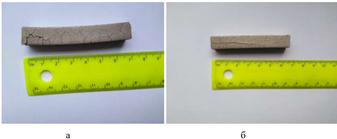
Рис. 4.28. Вигляд зразків сплавів 59\text{Zr}-19\text{Ti}-22\text{Nb} (а) і 35\text{Zr}-39,5\text{Ti}-25,5\text{Nb} (б) після їх насичення воднем.
