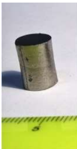
Рис. 2.8. Загальний вигляд зразків для досліджень процесів високотемпературної повзучості.
