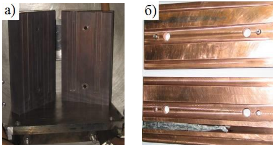
Рис. 2.6. Мідний гартувальний блок для НШОР (а) – двомісна ливарна пластинчата форма перерізом 2 \times 10 \times 250 \text{ мм}^3 та 5 \times 20 \times 250 \text{ мм}^2 ; (б) – клиновидна гартувальна форма (3 \times 10 - 2 \times 8) \times 160 \text{ мм}^2
