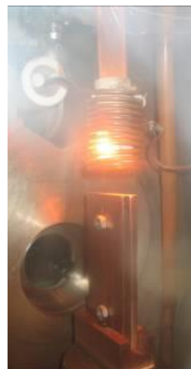
Рис. 2.5. Установка для ВЧ-плавки та отримання об'ємноаморфізованих злитків (пластин та стрижнів) перерізом від 3 до 200 мм 2
