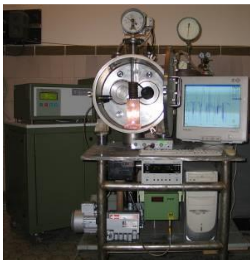
Рис. 2.5. Установка для ВЧ-плавки та отримання об'ємноаморфізованих злитків (пластин та стрижнів) перерізом від 3 до 200 мм 2
