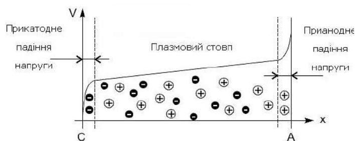
Рис. 4.3 Схематичний розподіл потенціалу між анодом і катодом.
