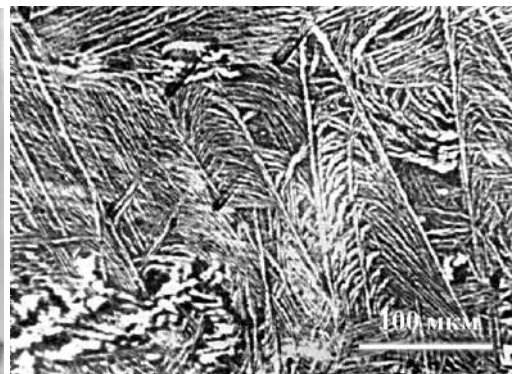
Рис. 1.8 Виділення \text{Ni}_3\text{Al} ( \gamma' -фази) в сплаві \text{Ni}_{67}\text{Al}_{33} , отриманого електродуговою плавкою
