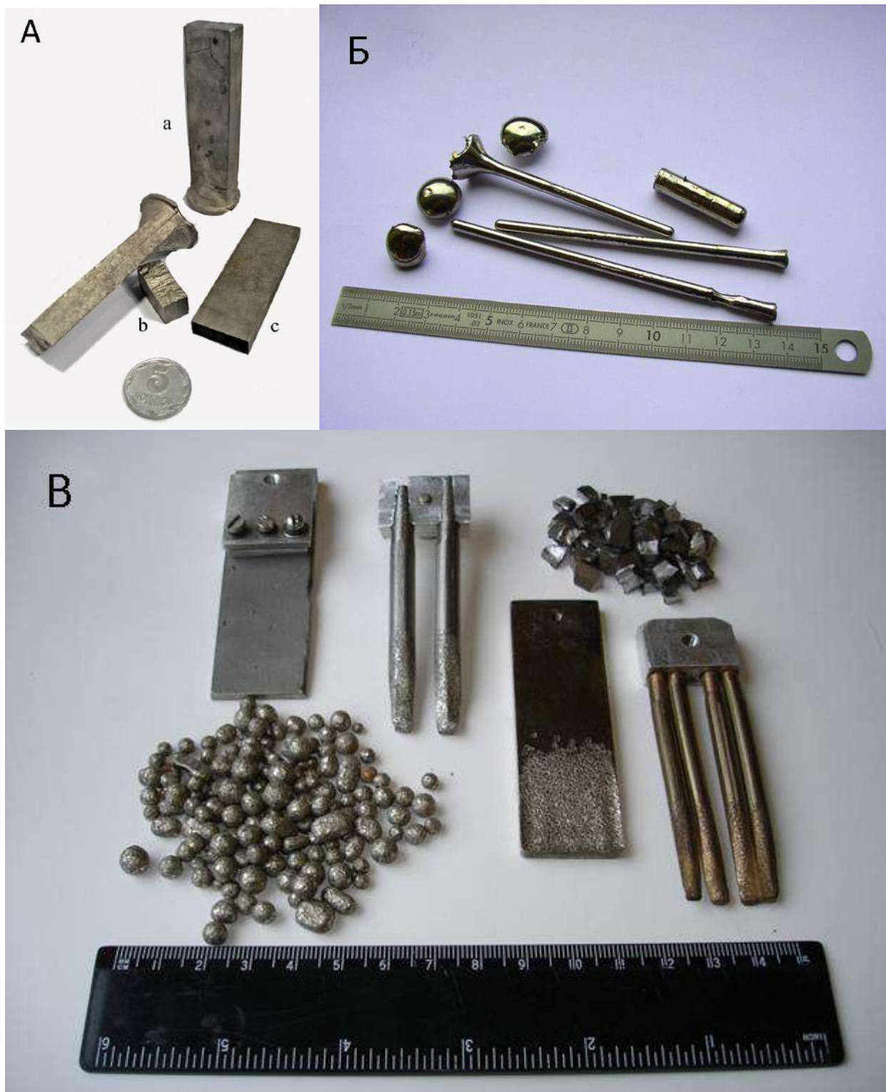
А) – вилівка (а) сплаву Ni-Mn-Ga, виплавленої індукційною плавкою, її скол (б) та електрод, вирізаний електроіскровим методом (в); Б) – відливки сплаву Zr-Ni-Cu-Al-Ti, виплавленого дуговою плавкою; В) – електроди в утримувачах різних конструкцій та гранули до (зверху) і після (знизу) ОЕІД.
