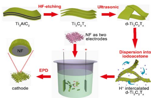
Рис. 4.3. Загальна схема одержання \text{Ti}_3\text{C}_2\text{T}_x MXene та виготовлення електроду на його основі.
