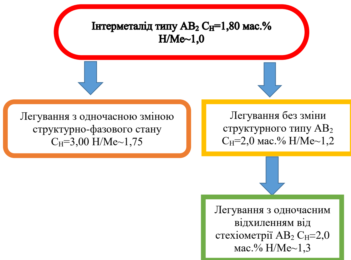
Рис. 6. Схема впливу легування на фазово-концентраційний склад та водневосорбційні властивості інтерметаліду типу AB_2 .
