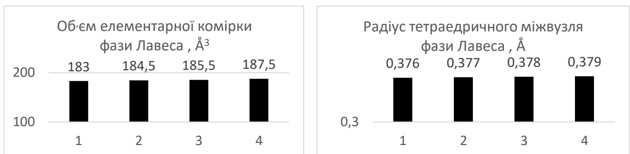
Рисунок 1 – Об'єм елементарної комірки та радіус тетраедричного міжвузля фази Лавеса типу C14 для сплавів: 1 - (\text{Ti}_{0,34}\text{Zr}_{0,66})\text{Mn}_{1,2} ; 2 - (\text{Ti}_{0,34}\text{Zr}_{0,66})\text{Mn}_{1,1}\text{V}_{0,1} ; 3 - (\text{Ti}_{0,34}\text{Zr}_{0,66})\text{Mn}_{0,96}\text{V}_{0,12}\text{Cr}_{0,11} губка; 4 - (\text{Ti}_{0,34}\text{Zr}_{0,66})\text{Mn}_{0,96}\text{V}_{0,12}\text{Cr}_{0,11} титан йодидний.
