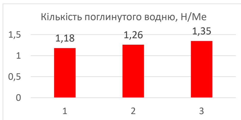
Рис. 4.8. Кількість поглинутого водню сплавом: 1 - Ti_{15,4}Zr_{30,2}Mn_{54,4} [66]; 2 - Ti_{16,3}Zr_{36,4}Mn_{47,3} ; 3 - Ti_{42}Zr_{24,3}Mn_{33,7}
