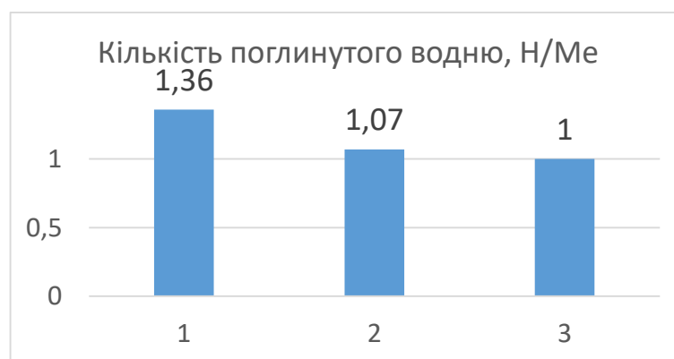
Рис. 4.27. Кількість поглинутого водню сплавом: 1 – \text{Ti}_{42}\text{Zr}_{24,3}\text{Mn}_{33,7} ; 2 – \text{Ti}_{54}\text{Fe}_{20}\text{Mn}_{26} ; 3 – \text{Ti}_{51}\text{Fe}_{13}\text{Mn}_{36}
