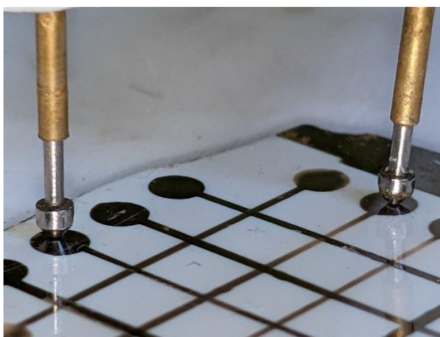
Рис. 2.8. Забезпечення контакту зонда з наноплівкою при вимірюванні вольт-амперних характеристик
