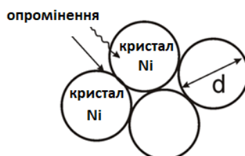
Рис.4.1. Схематичне зображення нанокристалічного Ni у формі ідеальних сферичних зерен діаметром d
